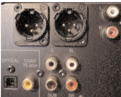
Το DVA250B διαθέτει μία στερεοφωνική balanced έξοδο, ένα σέτ 5.1 καθώς και δύο ψηφιακές εξόδους.
