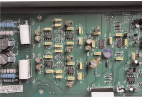
Το ψηφιακό στάδιο (δεξιά) και το αναλογικό στάδιο με τους τελεστικούς ενισχυτές NE5532 (αριστερά).
