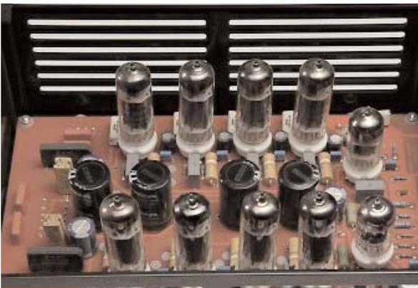
Το στάδιο ισχύος είναι push pull, πολωμένο σε τάξη A και χρησιμοποιεί τέσσερις πεντόδους EL84 ανά πολικότητα. Στο δεξί μέρος της φωτογραφίας φαίνεται το στάδιο οδήγησης (12AX7/12AU7) και αριστερά οι δύο γέφυρες ανόρθωσης.
