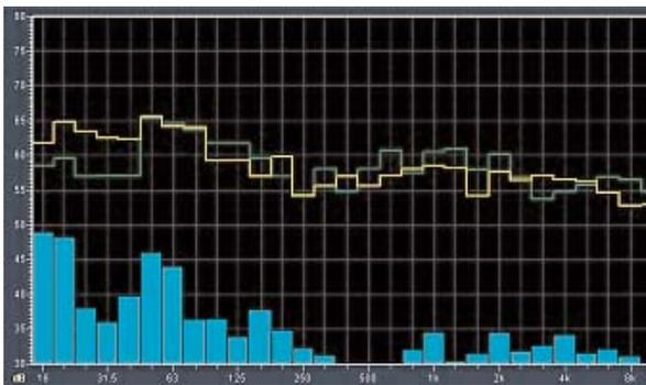
RTA (δύο ηχεία στη θέση ακρόασης), Room Analyzer, σήμα λευκός θόρυβος. Πράσινη καμπύλη flat, κίτρινη ισοσταθμισμένη μέσω του Corland DRC 205.
