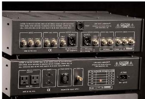
Ο προενισχυτής προσφέρει τρεις εισόδους στάθμης line, βρόχο εγγραφής και εξόδους single ended και balanced. Το τροφοδοτικό έχει ρευματοδότες καθώς και γραμμές ενεργοποίησης των τελικών ενισχυτών.
