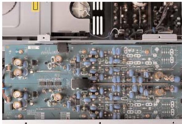
Το αναλογικό στάδιο ξεκινά από έναν Burr-Brown PMC1796 ανά κανάλι και χρησιμοποιεί τελεστικούς NE5532 και L49723 για την μετατροπή i/v, το φίλτρο και το buffering.
