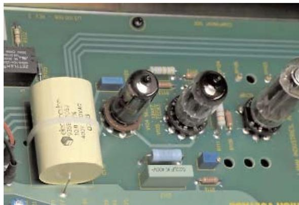
Αυτό, είναι το στάδιο του σταθεροποιητή τάσης στο τροφοδοτικό. Χρησιμοποιεί τρεις τριόδους (οι δύο λυχνίες αριστερά) και μια ειδική σταθεροποιητήρια (δεξιά).
