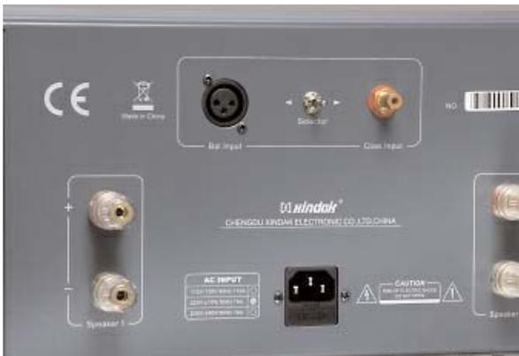
Ο τελικός ενισχυτής προσφέρει single ended και balanced είσοδο καθώς και δύο ζεύγη υποδοχών σύνδεση με το ηχείο.
