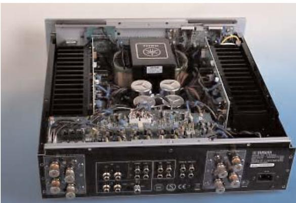
Όπως και στην περίπτωση του CD-S1000, το σασί του A-S1000 είναι καλο-κατασκευασμένο και άκαμπτο. Οι ψύκτρες του ενισχυτή είναι εσωτερικές. Όπως και στην περίπτωση του CD-S1000, το σασί του A-S1000 είναι καλοκατασκευασμένο και άκαμπτο. Οι ψύκτρες του ενισχυτή είναι εσωτερικές.
