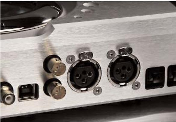
Ο μετατροπέας διαθέτει δύο εισόδους AES/EBU οι οποίες μπορούν να χρησιμοποιηθούν ως ζεύγος ώστε να μεταφερθούν σήματα με bitrate 176.4 και 192kHz.
