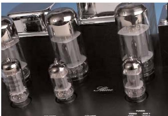
Το στάδιο εξόδου του ολοκληρωμένου ενισχυτή είναι push pull και χρησιμοποιεί δύο πεντόδους ανά κανάλι.
