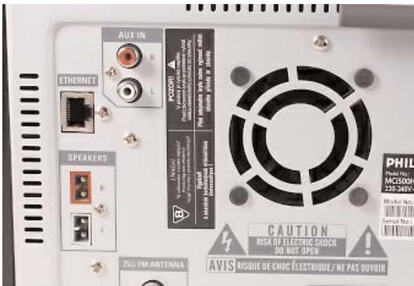
Δεν υπάρχουν και πολλά πράγματα εδώ: Είσοδος line, βύσμα για την σύνδεση στο δίκτυο, έξοδοι ηχείων και είσοδος κεραίας FM. Μας έλειψαν οι έξοδοι line και ψηφιακού σήματος.
