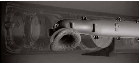
Το bass reflex σε μια καμπίνα με βάθος μικρότερο των 20 εκατοστών δεν είναι εύκολη υπόθεση. Χρησιμοποιούνται σωλήνες μεγάλου μήκους και άκρα Flowport για την μείωση των στροβιλισμών. Το κάτω όριο είναι 36Hz!
