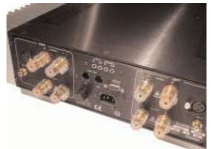
Ο CA-2100 προσφέρει εισόδους single ended και balanced, και δυο ζευγάρια υποδοχών για την σύνδεση ηχείων, επιτρέποντας έτσι την εύκολη διπλοκαλωδίωση.
