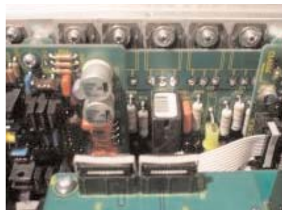
Το στάδιο εξόδου του CA-2100 χρησιμοποιεί δέκα διπολικούς ημιαγωγούς σε τάξη A/B. Κατά την εταιρία, ένας σημαντικός αριθμός bat είναι σε τάξη «A»..
