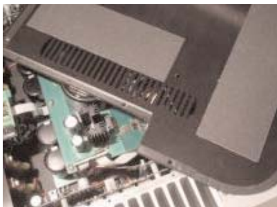
Τα καλύμματα των δύο συσκευών διαθέτουν φύλλα αποσβεστικού υλικού για την μείωση των χρωματισμών, παρά το μεγάλο πάχος τους.
