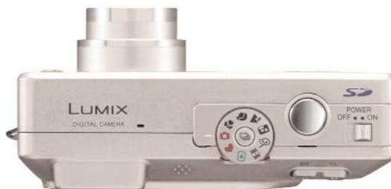
*Πολλοί κατασκευαστές χρησιμοποιούν έναν περιστροφικό επιλογέα για εύκολη και γρήγορη αλλαγή των βασικών λειτουργιών της μηχανής.*
