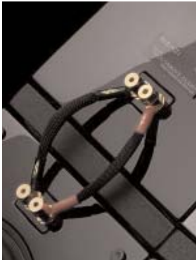
Η μεταφορά του σήματος από το τμήμα των χαμηλών συχνοτήτων προς την κεφαλή γίνεται μέσω δύο μικρού μήκους καλωδίων.
