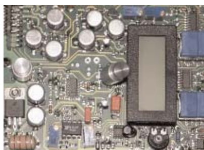
Ο σύγχρονος κινητήρας του Ambient (αριστερά) οδηγείται ηλεκτρονικά. Στο δεξί μέρος της φωτογραφίας φαίνονται τα δύο τρίμερ για την μικρορύθμιση των στροφών.
