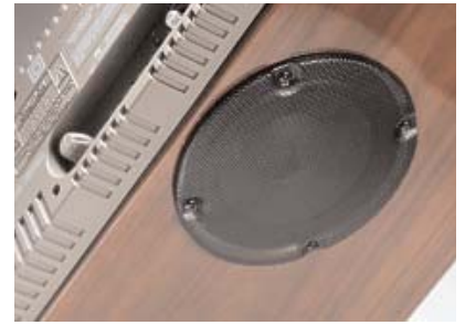
Ένα «τρίτο» μεγάφωνο το οποίο ακτινοβολεί προς το κάτω μέρος της συσκευής έχει αναλάβει την υποβοήθηση των κυρίως ηχείων στις χαμηλές συχνότητες και το κάνει με επιτυχία.
