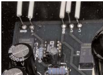
Σε αυτό το ολοκληρωμένο (SSM2141 της Analog Devices) αθροίζονται οι δύο κλάδοι της balanced τοπολογίας για να οδηγηθούν τα RCA της single ended εξόδου.
