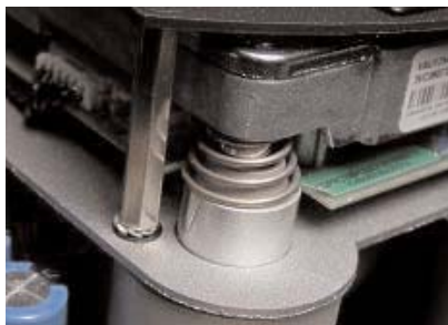
Το τρανσπόρτ της Philips πατά σε τέσσερε κωνικά ελατήρια για την απόσβεση των κραδασμών.
