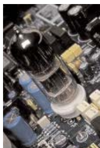
Το αναλογικό στάδιο του Endorphin χρησιμοποιεί μία διπλοτρίοδο 6H30PI της Sovtek σε καθαρή τάξη Α, χωρίς αρνητική ανάδραση και σε balanced τοπολογία.
