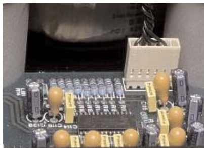
Ο μετατροπέας που χρησιμοποιείται είναι ο CS4396 της Crystal, 24bit/192kHz με balanced εξόδους.
