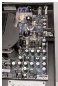
Η Pathos δεν έχει κάνει οικονομία στα τροφοδοτικά. Μετρήσαμε τουλάχιστον επτά. Στο κάτω μέρος φαίνονται οι διακόπτες ελέγχου του transport.
