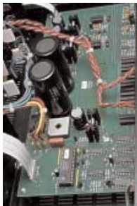
Το πυκνωτικό φίλτρο αποτελείται από δύο πυκνωτές των 22.000µF.
